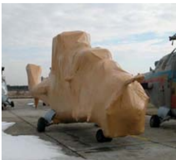
Slika 21: Primjena inhibitora korozije za zaštitu borbenih letjelica[12]
