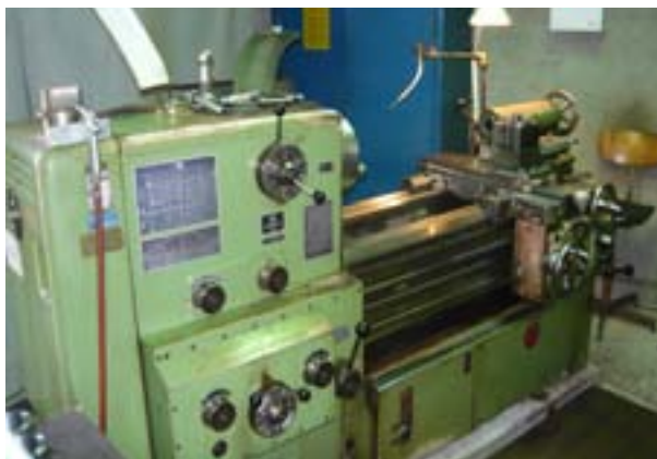
Slika 38: Tokarilica Prvomajska sistem Niles
